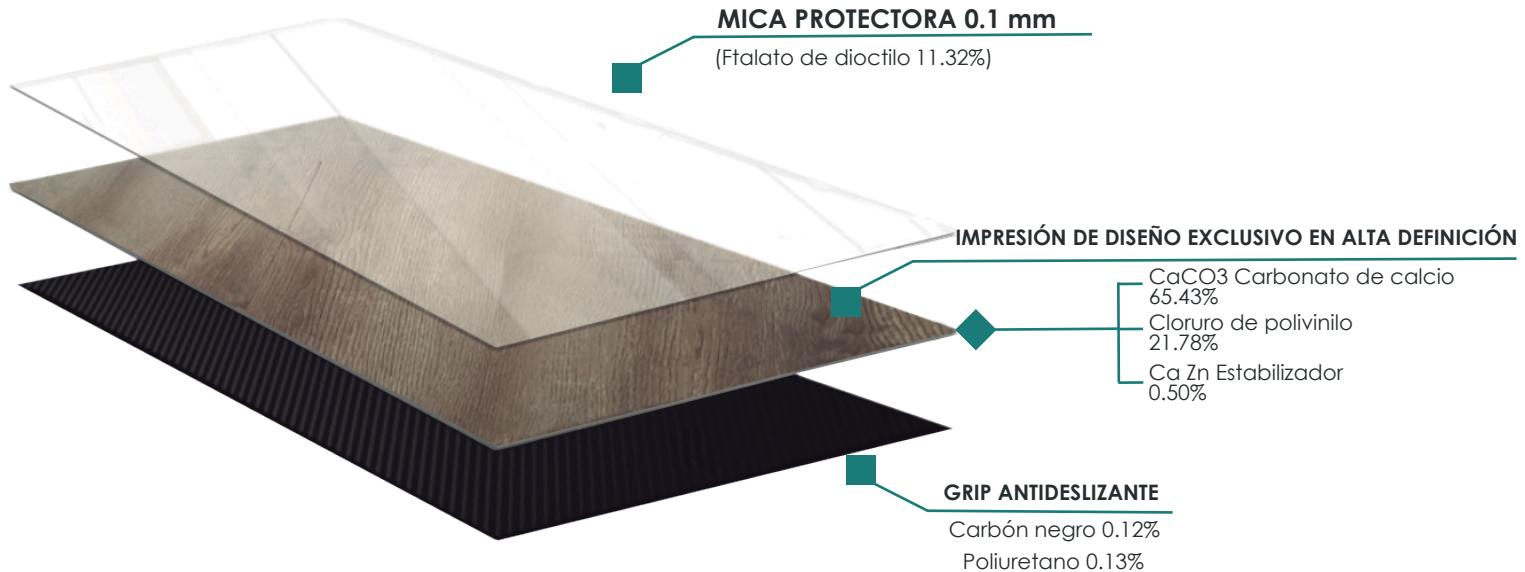
Sistema LVT que puedes instalar en piso, pared, techo, muebles, etc... Requiere de pegamento para su instalación. Cuenta con certificaciones internacionales que lo avalan como un piso ecológico, higiénico y que no necesita mantenimiento. Está compuesto por carbonato de Calcio y Zinc, lo cual nos ayuda a que sea estable y térmico, por lo que no sufre cambios en su estructura con cambios climáticos.
